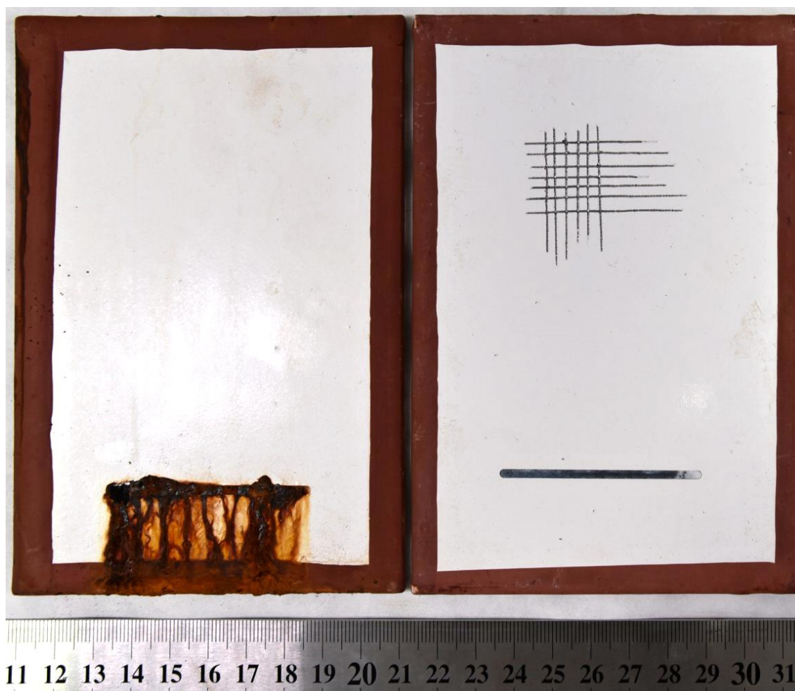
Obr. 2 Vzhled vzorků se základním nátěrem plněným recyklovaným zinkovým prachem FZNP 15H ES po 5040 hodinách zkoušky v neutrální solné mlze (vlevo) a kondenzační zkoušce (vpravo)
